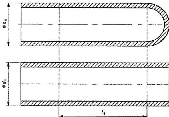
Hình 1 – Mẫu thử được tạo hình bằng ép phun
