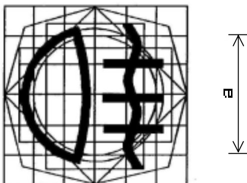
Hình D.12 - Đèn sương mù sau (Màu của ánh sáng báo hiệu làm việc: màu vàng hổ phách)
