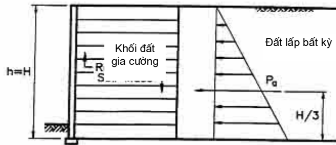
Hình 3.11.5.7-1 - Phân bố áp lực đất trên tường MSE với mặt đất đắp nằm ngang
