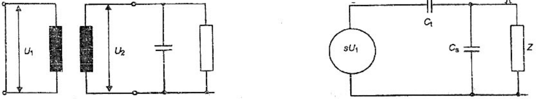
Hình B.1 – Mạch điện tương đương đối với sự truyền điện dung do quá điện áp
