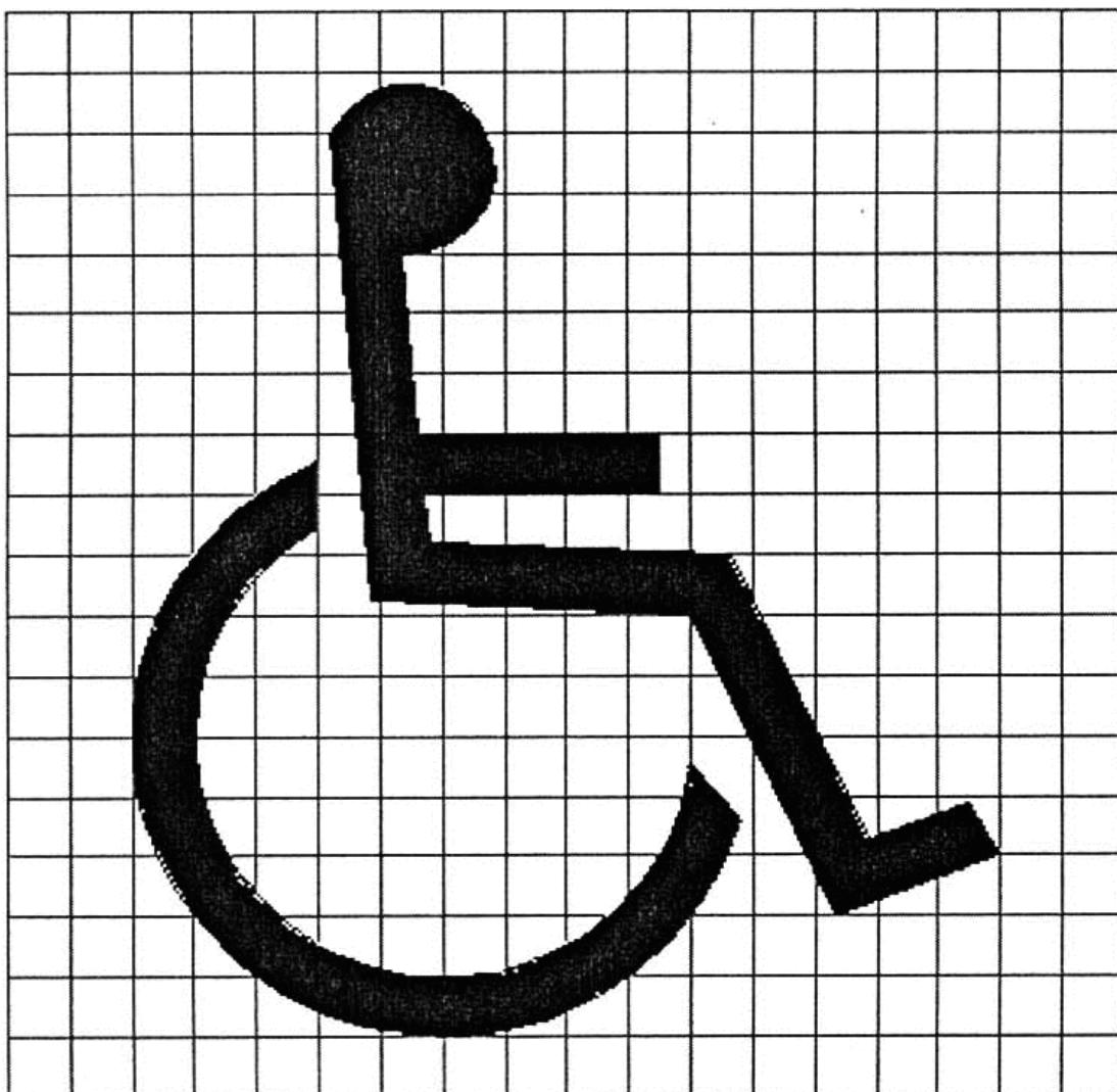
Hình dáng và tỷ lệ ký hiệu xe dùng cho người tàn tật (kích thước, màu sắc ký hiệu do cơ sở sản xuất tự thiết kế theo tạo dáng và mỹ quan bên ngoài của xe).
