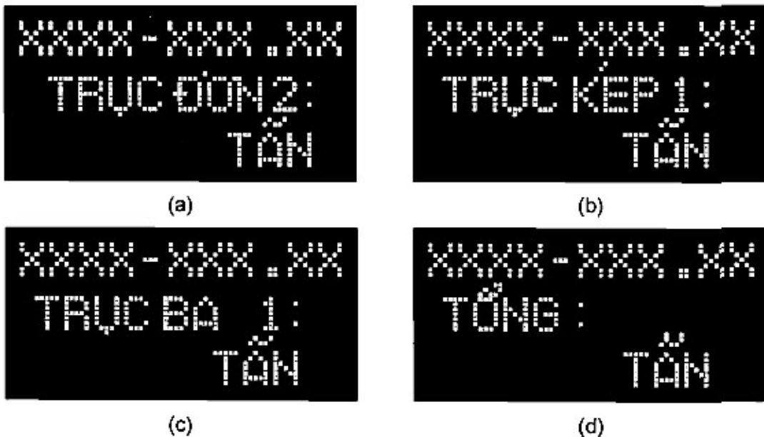
Hình 16. Ví dụ về biển báo VMS các thông báo các tải trọng cân thứ cấp gắn với biển số xe (XXXX-XXX.XX là biển số xe)
