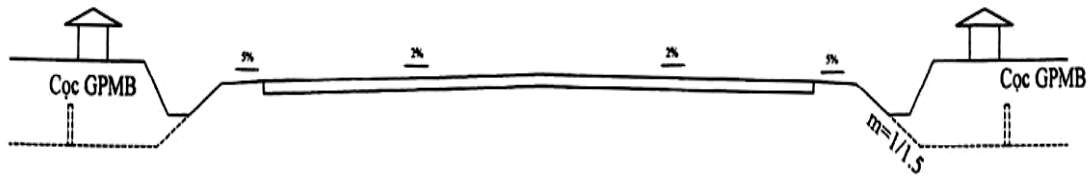
Hình 3: Sau khi đào trả rãnh dọc, đất của đường bộ còn lại từ 1 -:- 1.5 m
