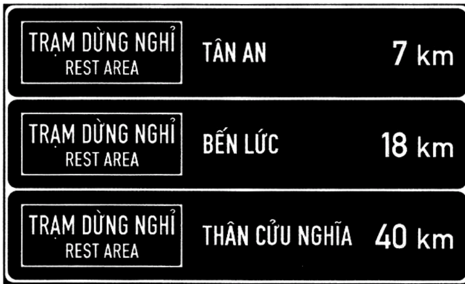
Hình 14. Biển số 458 chỉ dẫn khoảng cách đến trạm dừng nghỉ tiếp theo
