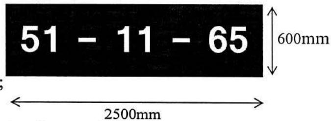
c) Loại tàu hàng có trọng tải từ 400 tấn đến 550 tấn
