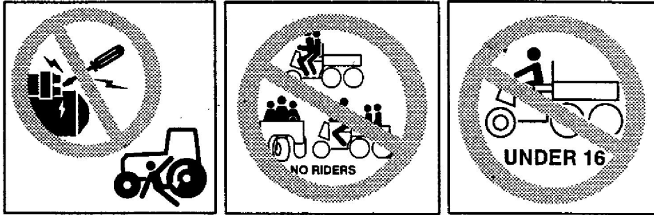
Hình D.30 - Các mẫu hình vẽ sử dụng vòng tròn đỏ có đường gạch chéo để thông báo ý kiến về hành động bị cấm
