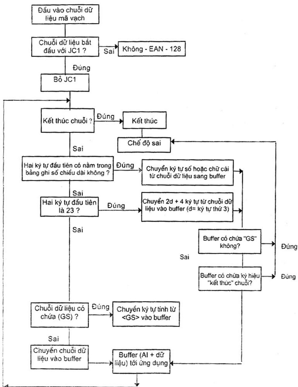
Sơ đồ xử lý này đưa ra logic cơ bản cần cho việc xử lý chuỗi dữ liệu từ một mã vạch EAN-128. Đây có thể chưa phải là phương án phần mềm tối ưu. Nó chỉ giả định rằng thiết bị quét đưa ra JC1 để phân định EAN-128 và <GS> (ASCII 29) cho tất cả các ký tự mã vạch FNC1 tiếp sau FNC1 ở tại vị trí ký tự đầu tiên tiếp sau ký tự bắt đầu.
