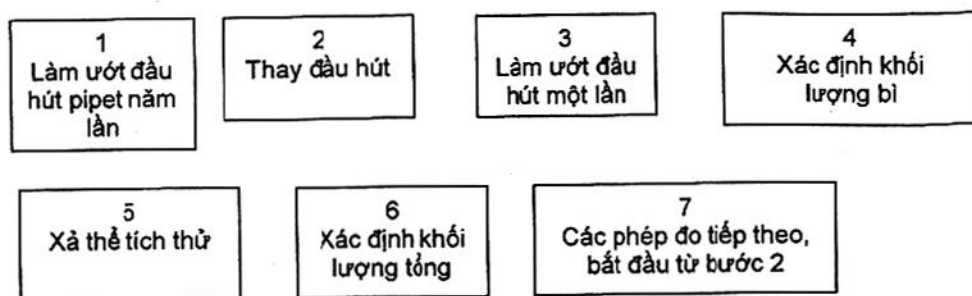
Hình 2 – Sơ đồ quy trình thử pipet pittông có mặt phân cách không khí
