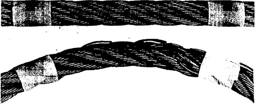
Hình 7 – Uốn cong cáp thường làm lộ sợi đứt ẩn tại vùng khe giữa các tao cáp
