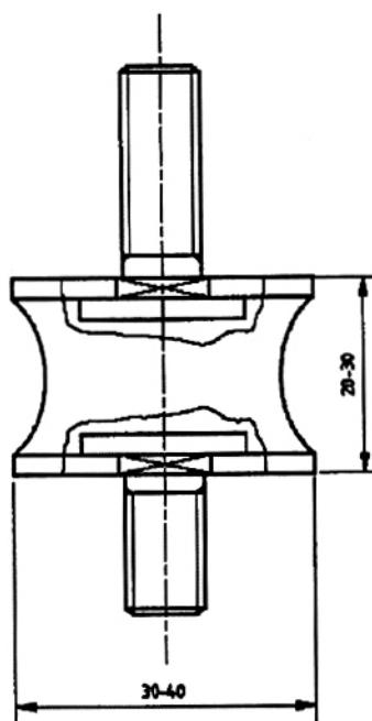
**Hình 5 – Đệm cao su diễn hình dùng để đốt thang thử nghiệm**
