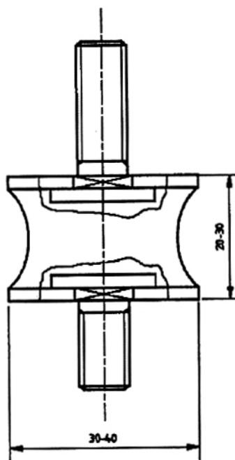
Hình 4 – Đệm cao su diễn hình dùng để đỡ thang thử nghiệm
