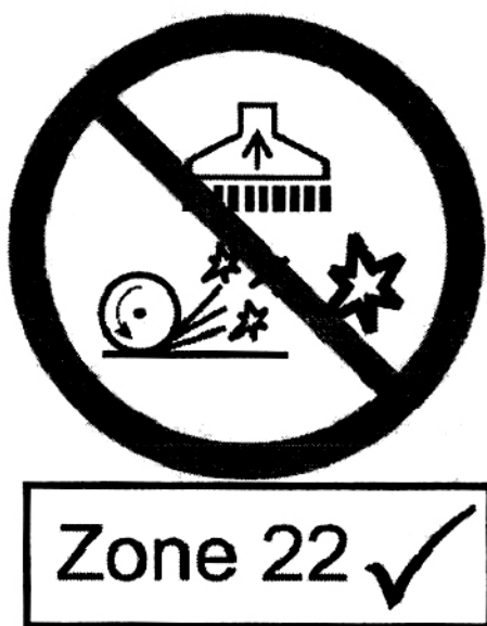
Hình CC.2 – Ghi nhãn – Cơ cấu hút bụi loại 22
