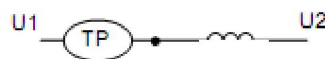
Hình 14 – Dây quấn chính một pha, bộ bảo vệ nhiệt nối tích hợp, một phần tử
