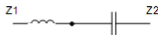
Hình 13 – Dây quấn phụ một pha, tụ điện nối tích hợp, một phần tử
