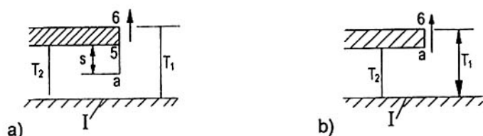
Hình A9 - Sơ đồ xác định áp lực tại đầu dưới của ván cừ ở chỗ ra.
