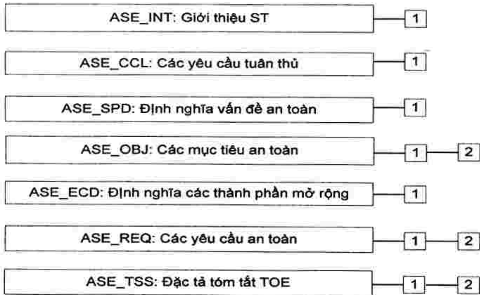
Hình 9 – Phân cấp lớp ASE: Đánh giá Đích an toàn
