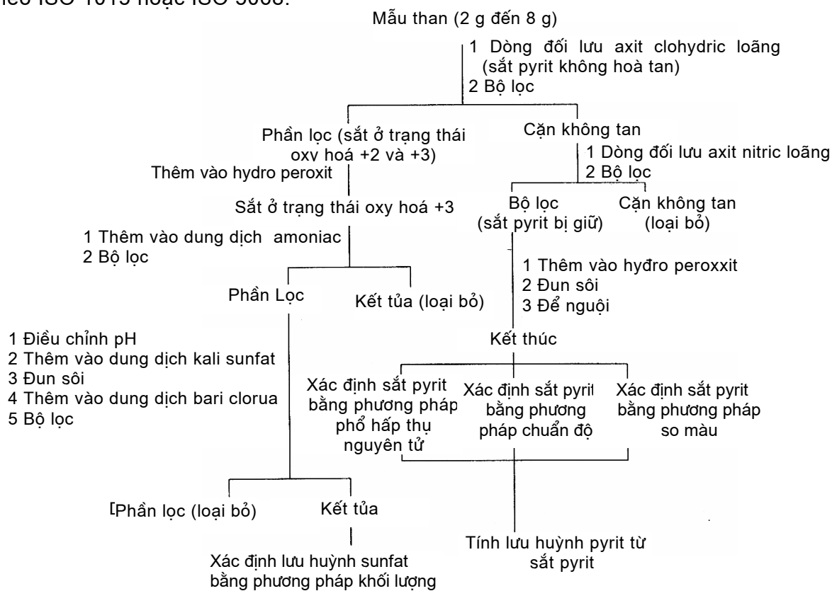
Hình 1 – Sơ đồ mô tả quy trình chung
