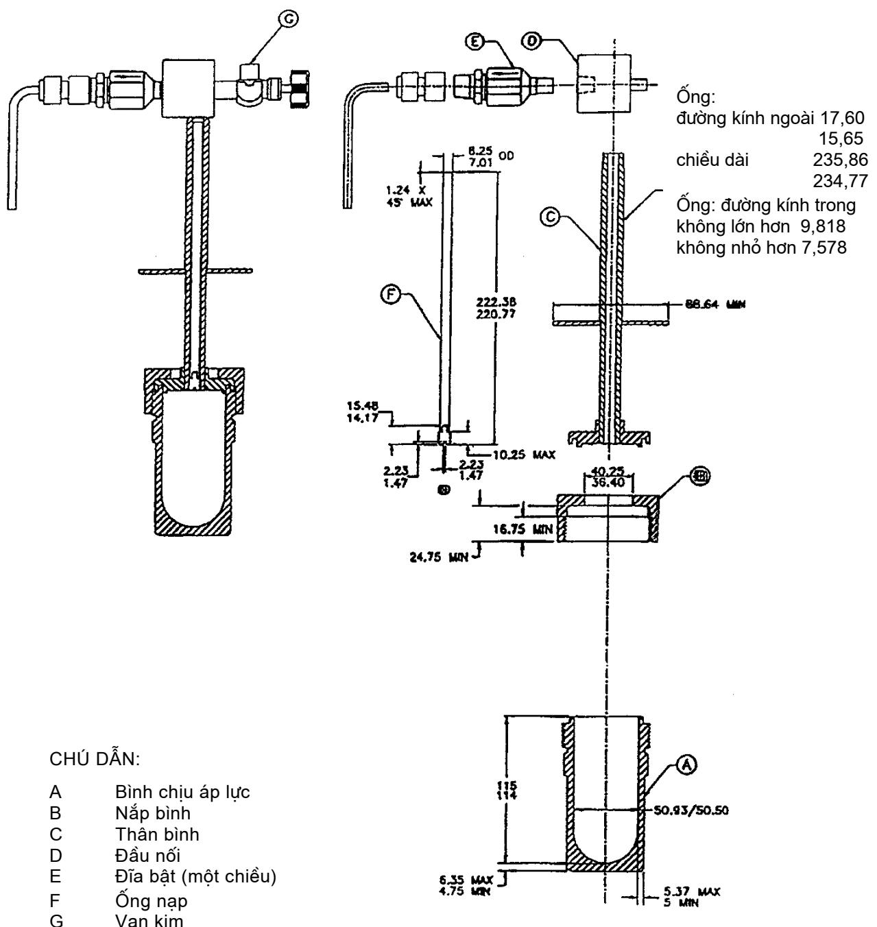
**Hình A.1.1 – Sơ đồ bình chứa áp lực để xác định độ ổn định ôxy hóa của xăng**
