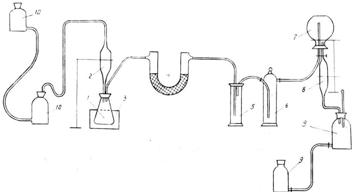
Hình 2. Thiết bị dùng để xác định lượng khí hidro sunfua và hidro photphua
