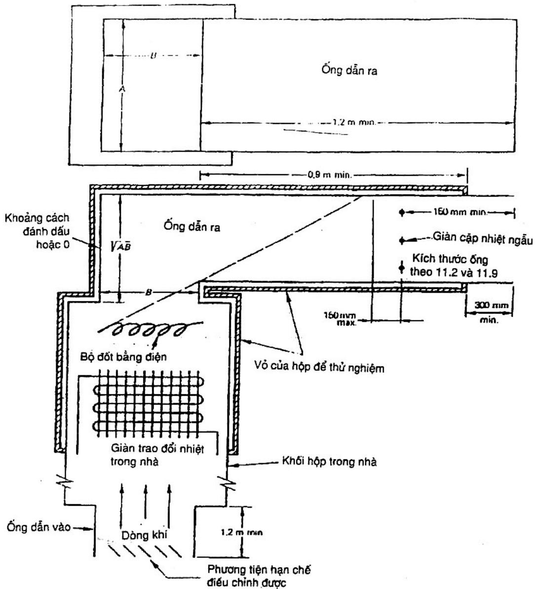
Hình 101a – Bố trí thử nghiệm đốt nóng cho các thiết bị có bộ đốt nóng phụ - chế độ dòng khí đi lên
