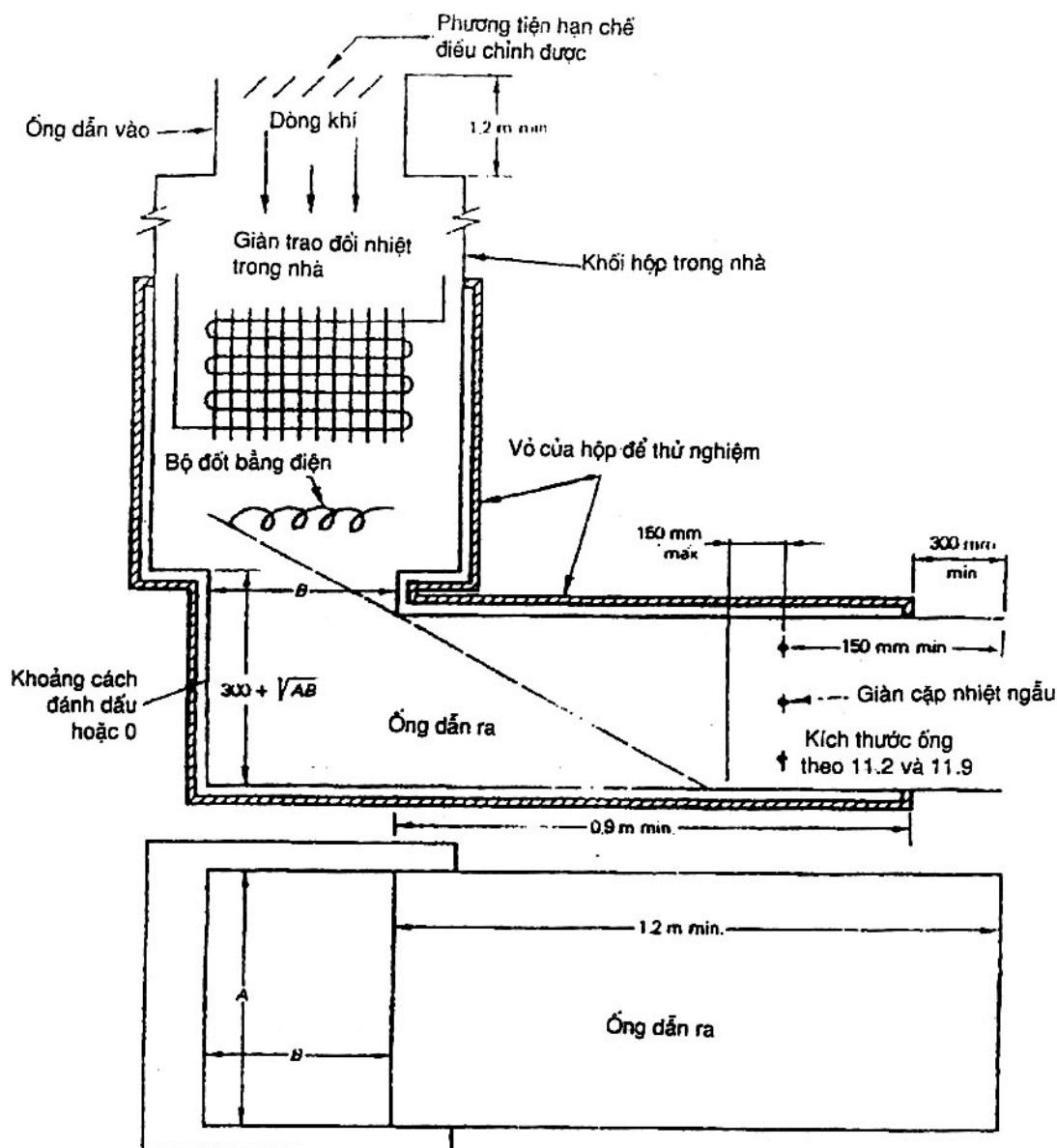
Hình 101b – Bố trí thử nghiệm đốt nóng cho các thiết bị có bộ đốt nóng phụ -
