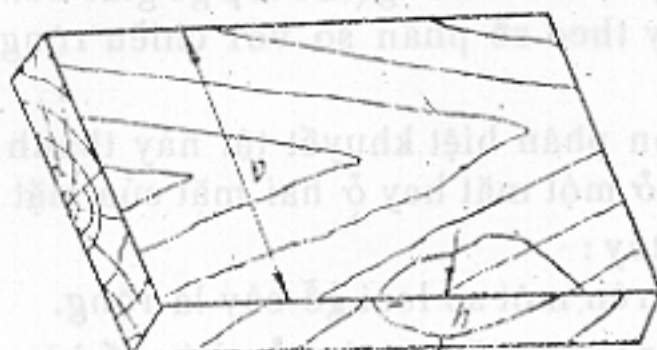
Hình 16 – Đo thớ uốn xoắn trên ván xẻ tiếp tuyến
