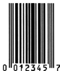
Hình B.2 – Mã vạch UPC-E (Mã hóa 001234000057 bằng phương pháp nén số không)
