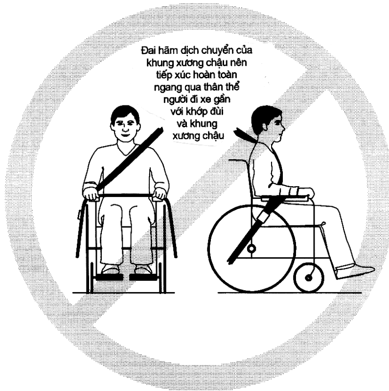
Hình 6 - Minh họa về việc lắp đai không đúng
