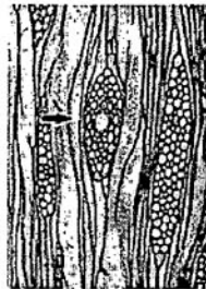
Hình 77 - Ống dẫn nhựa ngang trong tia gỗ trên mặt cắt tiếp tuyến
