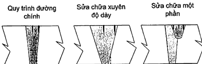
Hình 16 Minh họa việc định vị vạch dấu điển hình cho kiểm tra độ bền phá hủy của mối
