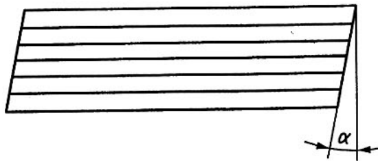
Hình 2 – Ví dụ về một góc \alpha của mặt cắt ngang, gỗ nhiều lớp (LVL)
