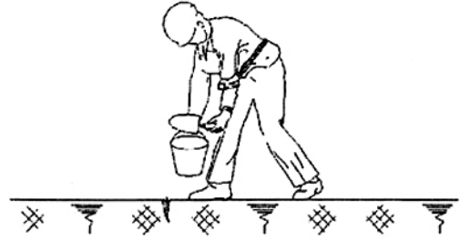
2. Xử lý cục bộ các vết nứt có bề rộng >5mm
