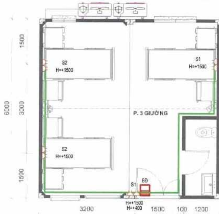
MẶT BẰNG CẤP ĐIỆN
