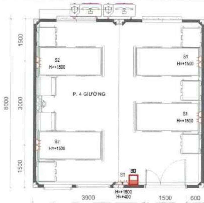
MẶT BẰNG CẤP ĐIỆN
