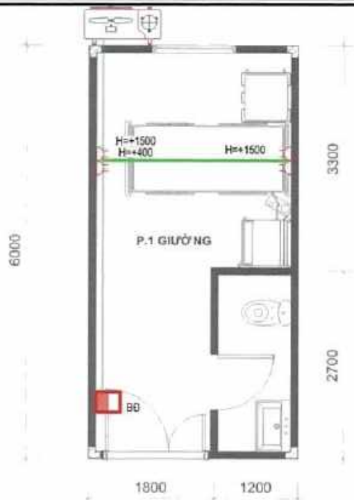
MẶT BẰNG CẤP ĐIỆN
